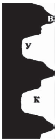
Фиг. 1. Схема на винтова спирала на имплантат: в – връх на спиралата, у – улей на спиралата, к – камера на спиралата
